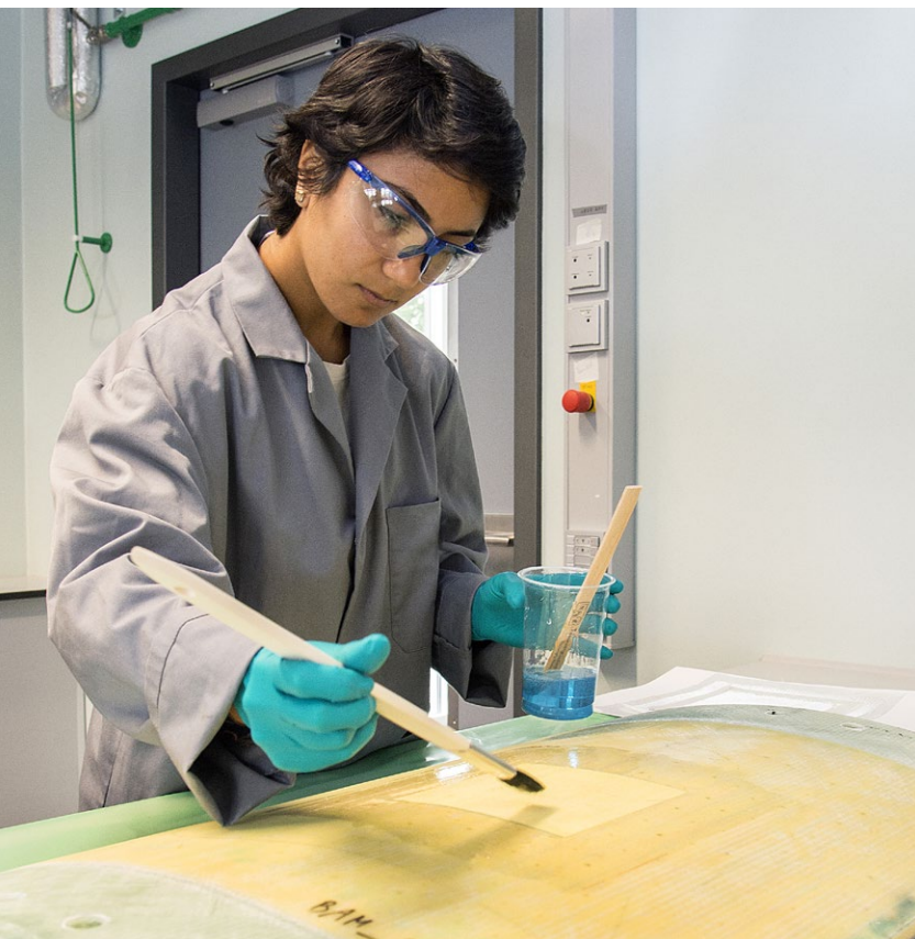
Reparatur von Faser-Kunststoff-Verbund im Labor
