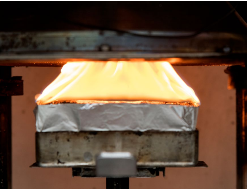
Test von flammgeschützten Polymerwerkstoffen
