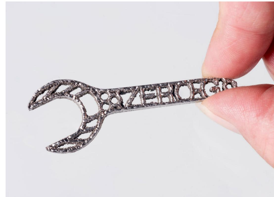
*Ein während der Zero-G-Experimente additiv gefertigter Schraubenschlüssel*
